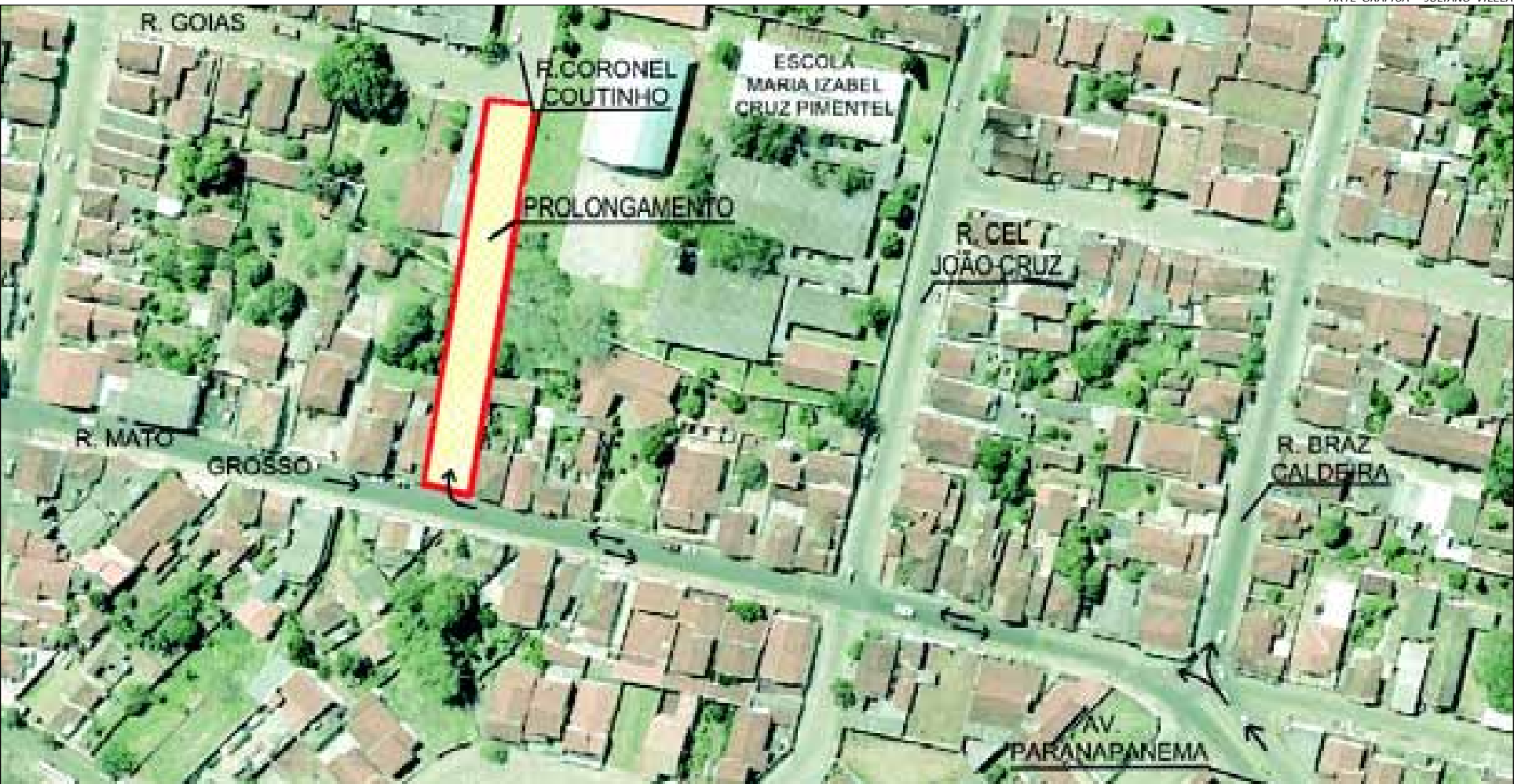
AEROFOTOGAMETRIA INDICANDO O NOVO ACESSO AO CENTRO DA CIDADE PARA QUEM VÊM DA AVENIDA PARANAPANEMA, MOSTRANDO AS INDICAÇÕES DO FUTURO SENTIDO DAS MÃOS DE TRÂNSITO, ATRAVÉS DAS SETAS INDICATIVAS
