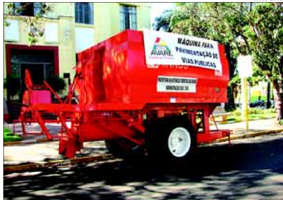
Equipamento é para execução de serviços de recapeamento asfáltico e asfaltamento de pequenos trechos
